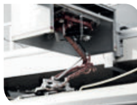
SYSTEM ŁADOWANIA Z PANTOGRAFEM ODWRÓCONYM – WYSUWAJĄCYM SIĘ Z ŁADOWARKI (TURKU, FINLANDIA)
